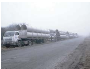
Camiones con 4, 5 y hasta 6 tubos DN 1100 mm de 14 mts de long.
