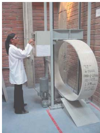
Figura 1 Equipo de ensayo de corrosión bajo deformación
