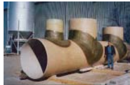
Se trata del accesorio más grande que Flowtite Argentina ha fabricado hasta ahora: una derivación en T triple de DN 1600, 10,5 m de longitud con dos ramales de DN 1600 y otra de DN 800.
