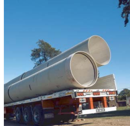
Transporte de Tubería a Obra DN 1200
